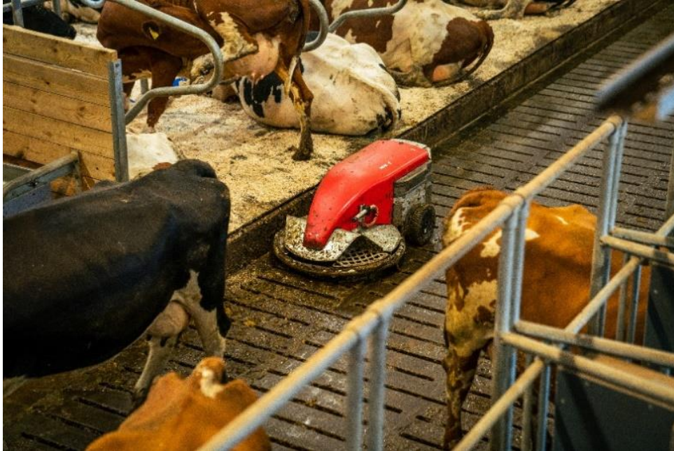
Bildetekst: Automatisk skraping ved bruk av robot.
