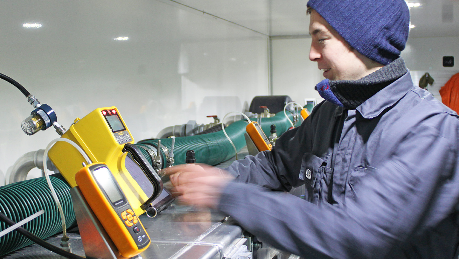
Norsk Sau og Geit har målt metangassproduksjon ved å bruke PAC – Portable accumulation chamber. Foto: Lars Erik Wallin.
