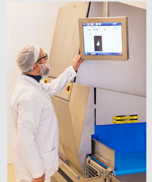
Meatmaster er et avansert instrument for måling av fett i produkter.
