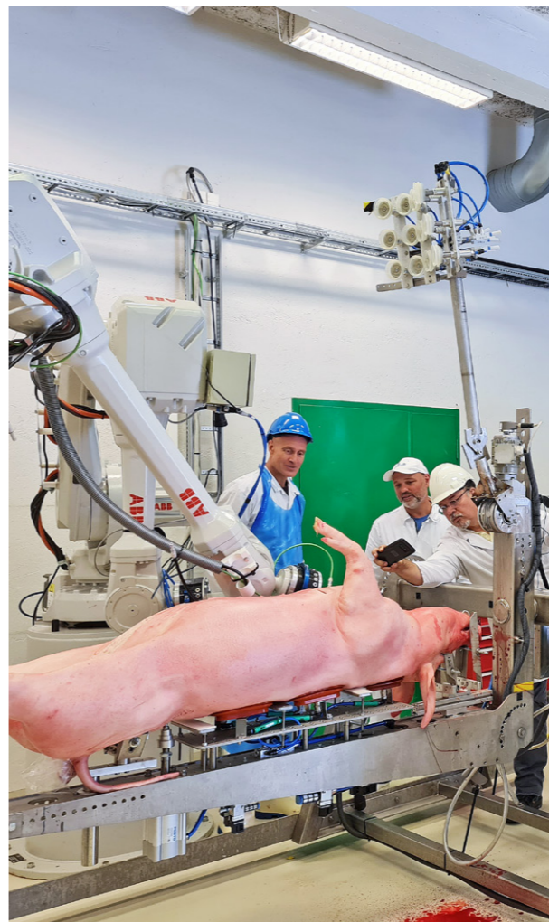
Praktisk veiledning av skjæring av gris til trening av robot i RoBUTCHER-prosjektet. Foto: RoBUTCHER
