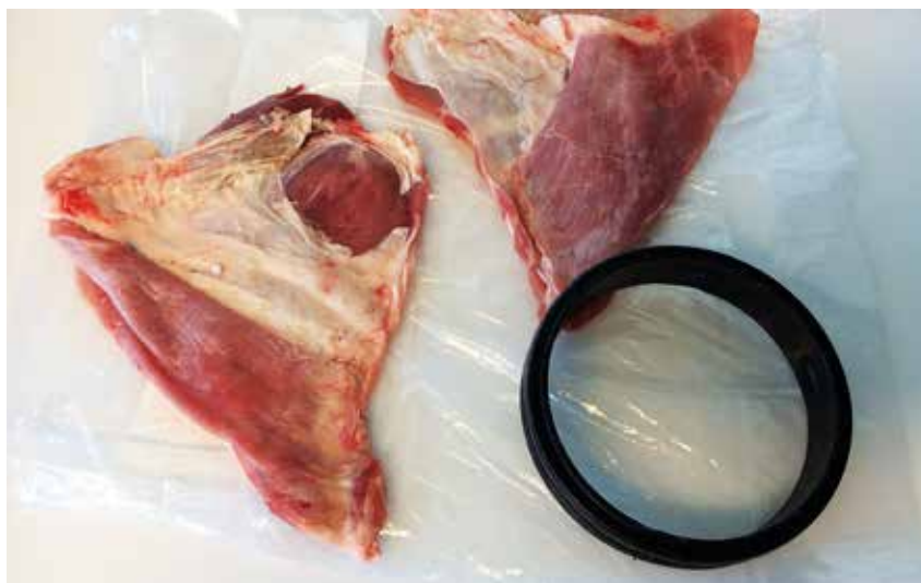
Slakteskrottmodellene ble konstruert av slagsider fra lam og dreneringsrør kappet i skiver.
