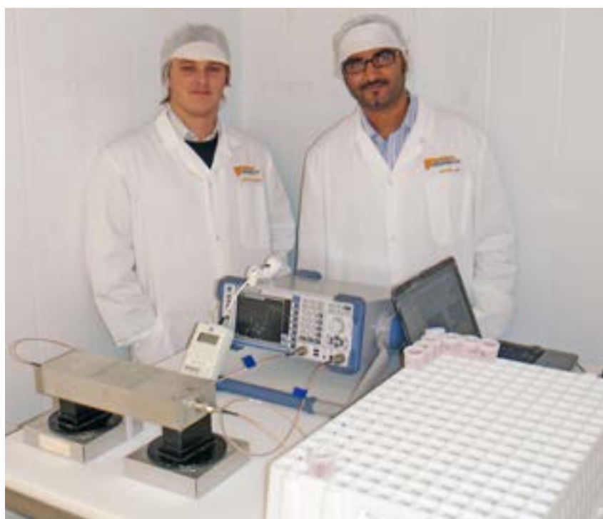
Forskerne fra Liverpool John Moores University, Alex Mason og Badr Abdullah, var på besøk en hel uke for å måle vannbinding ved bruk av mikrobølgeteknologi.
