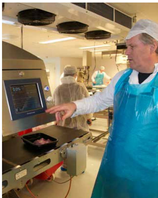
På Animalias forsøkskjærevdeling brukes nær infrarød skanner for å bestemme fettinnholdet i sorteringskjøtt. Foto: Frøydis Bjerke
