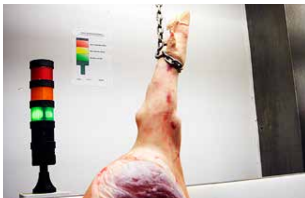
Et trafikklyssystem sørger for at skjæremønstret kan tilpasses på hvert slakt.
