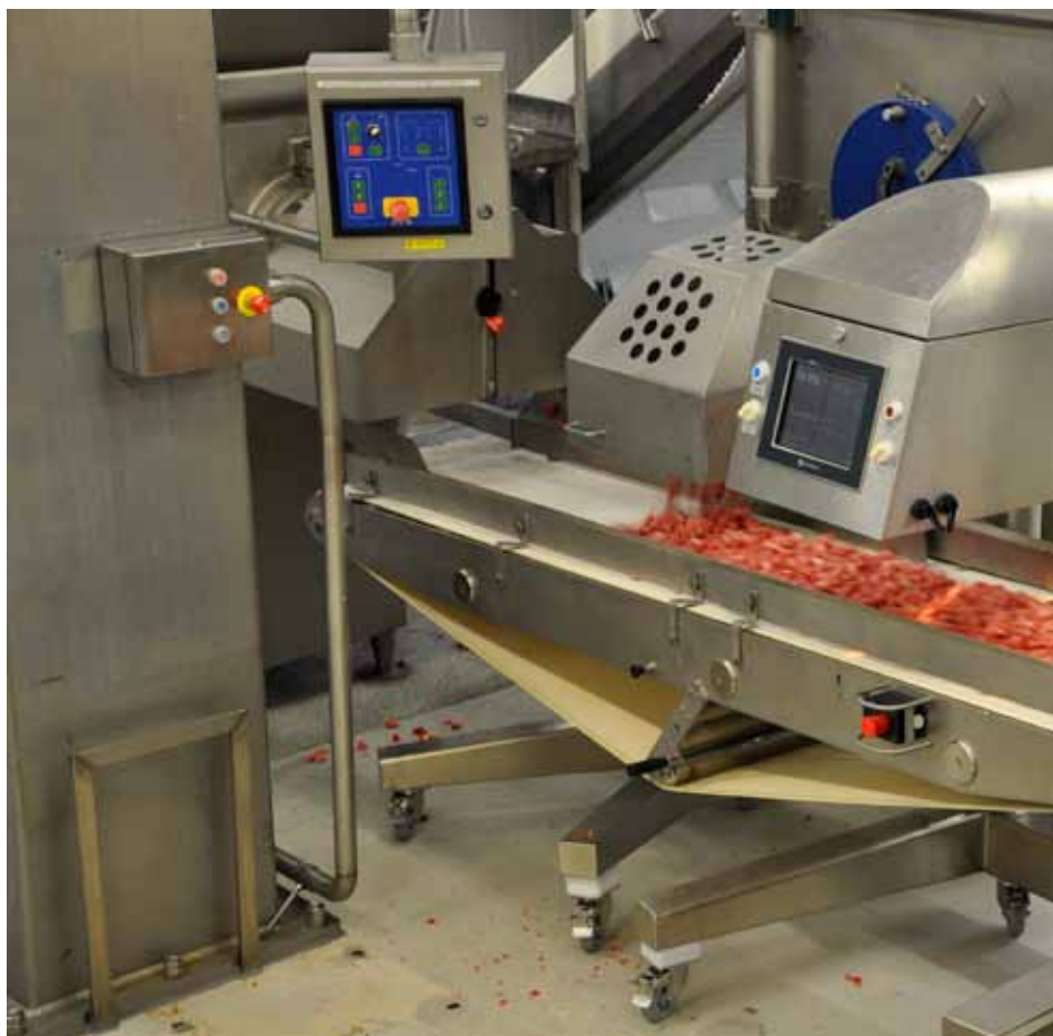
Her transporteres det fryste kjøttet under skanneren, og fettmåling foregår. Ferskt og til en skruemater til blanderen.
