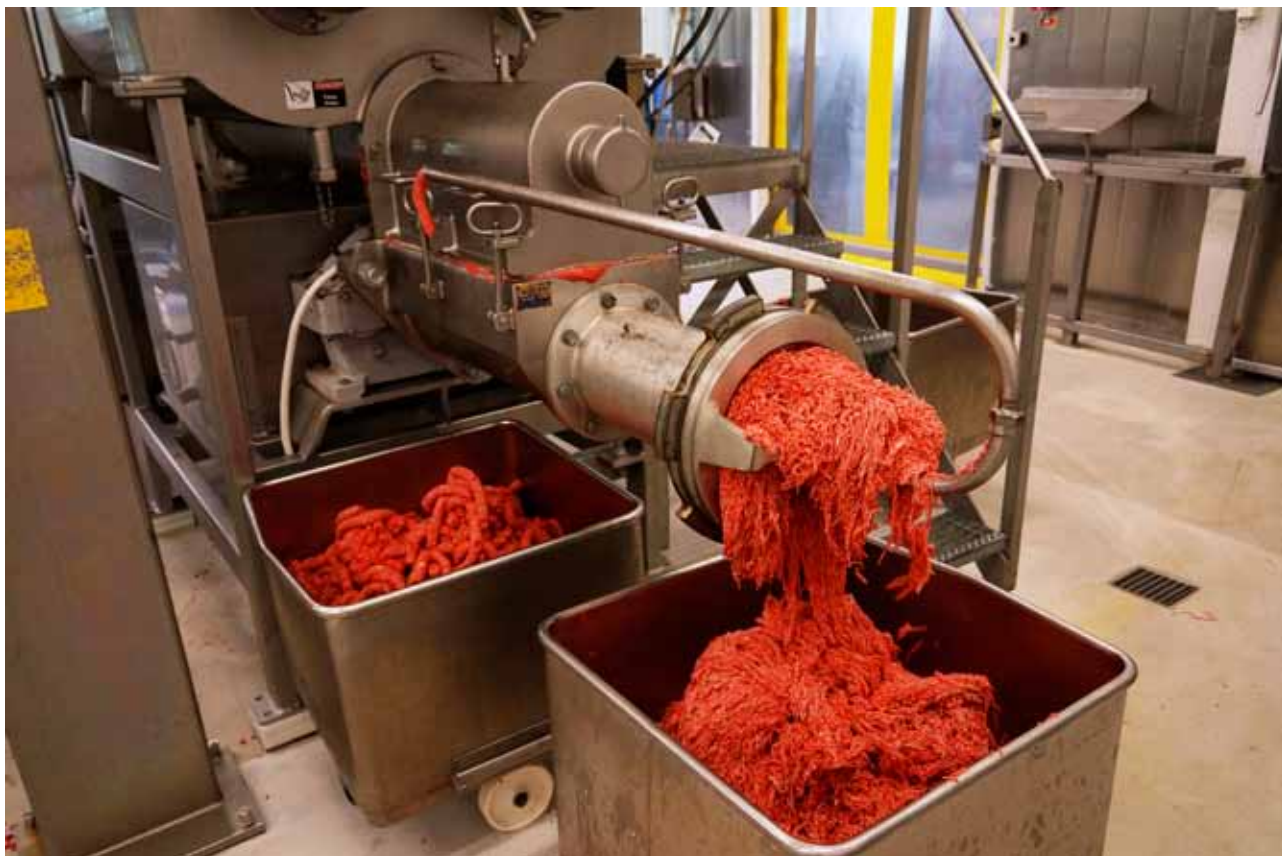
Her kommer ferdig kvernet hamburgerråstoff med riktig fettprosent. Den bakre vemaag-vogna inneholder utskilte sener etc.
