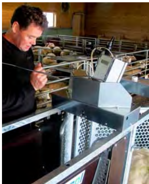
Mange sauebønder bruker elektroniske vektter med en RFID-leser. Det gjør arbeidet enklere, raskere og sikrere for sauebonden.
