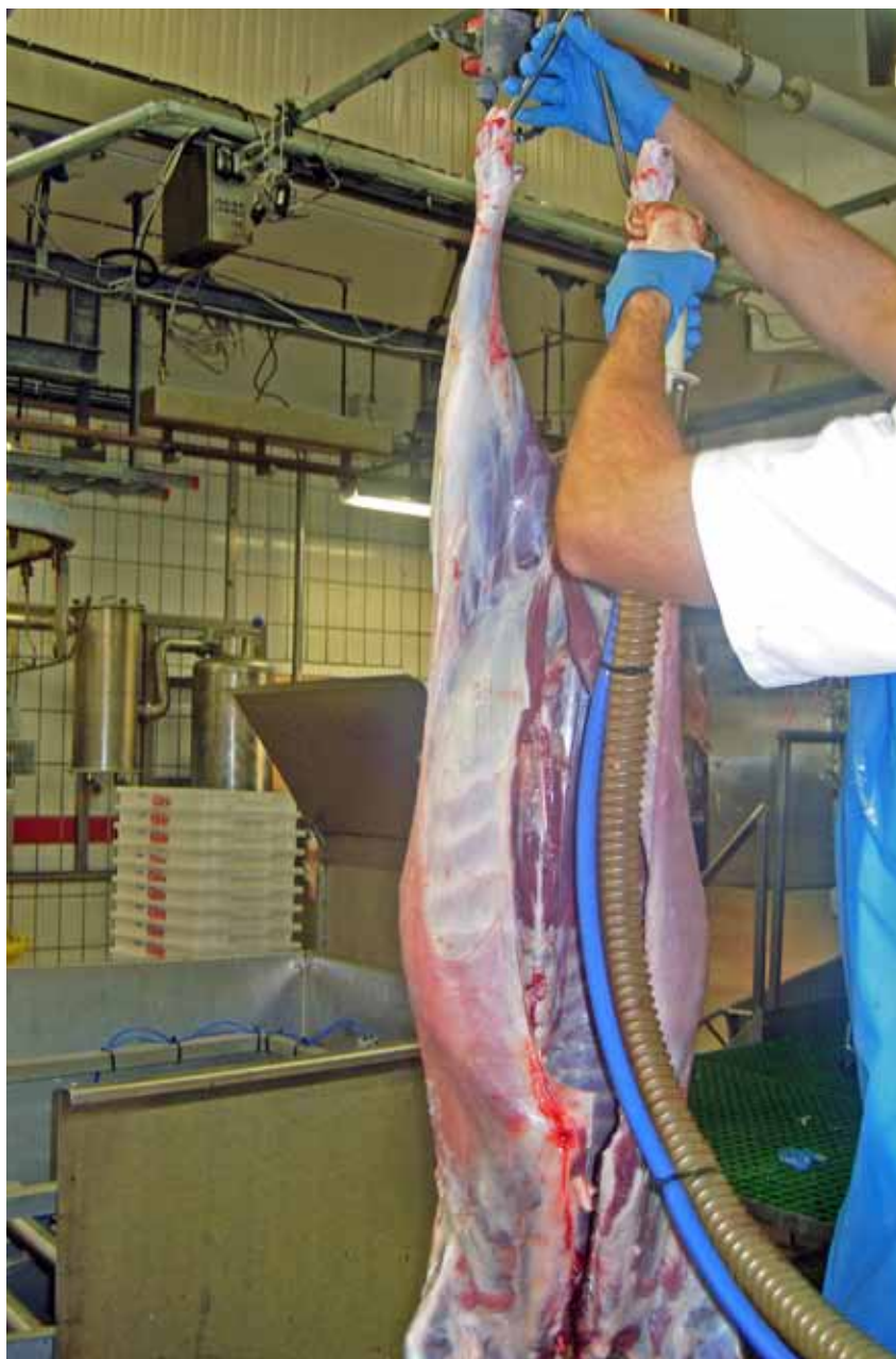
Bruk av håndholdt steam vacuum på lammeslakt. Dampen påføres på kritiske steder på undersiden av slaktet for å drepe bakteriene på slaktoverflaten.
