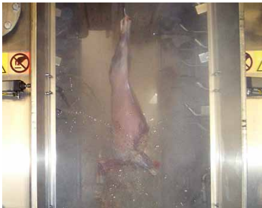
Varmtvannspasteurisering av lamme-slakt i kabinett ble utført med 82 °C vann i 8 sekunder.
