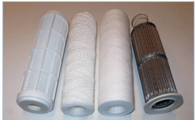
Ulike typer patronfiltre, fra venstre til høyre: Polyesterduk (spylbart), polyesterfiber spunnet, polyesterfiber slynget og metallfilter.
