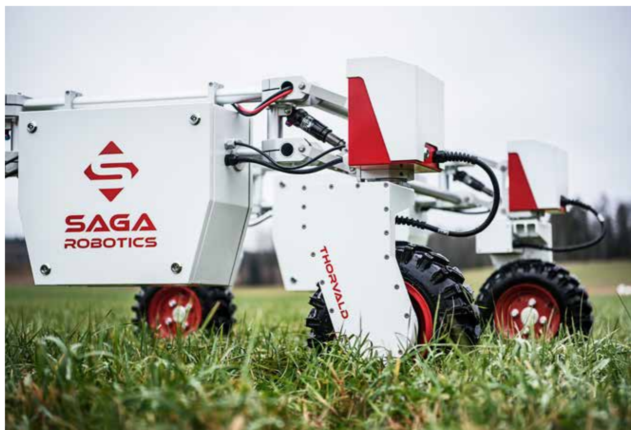
En av Saga Robotics sine roboter. Robotene settes sammen av ulike standardelementer som tilpasses den oppgaven roboten skal løse. Foto: Benjamin A. Ward / SAGA ROBOTICS.
