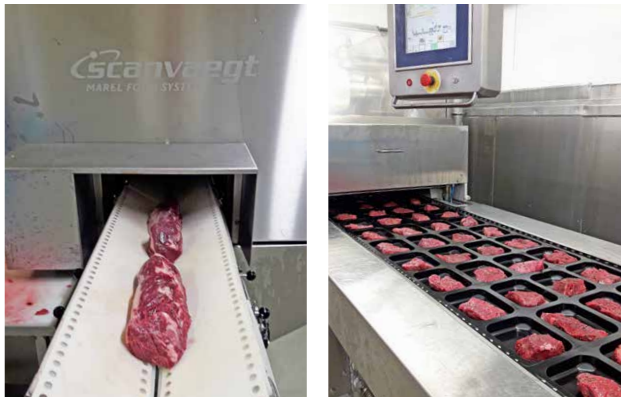
Fatland Ølen: Enhetsvekt på biffer til forbruker. De hele biffene avleses med et kamerasystem, snittstedene beregnes og justeres slik at vektene på biffstykkene blir tilnærmet like. Foto: Else Margrethe Aas.
