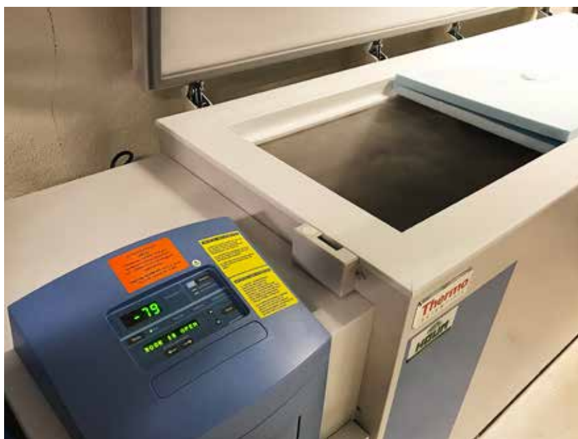
Ved Animalias pilotanlegg bruker vi en ultrafryseboks for veldig rask nedfrysing av kjøttprøver ved ca. -80°C.
